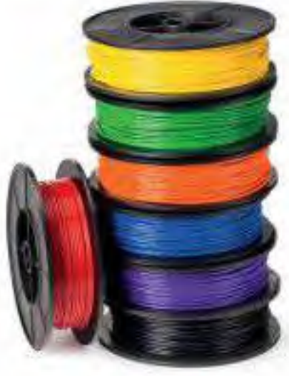
شكل 3.10: مواد بلاستيكية للطباعة ثلاثية الأبعاد
