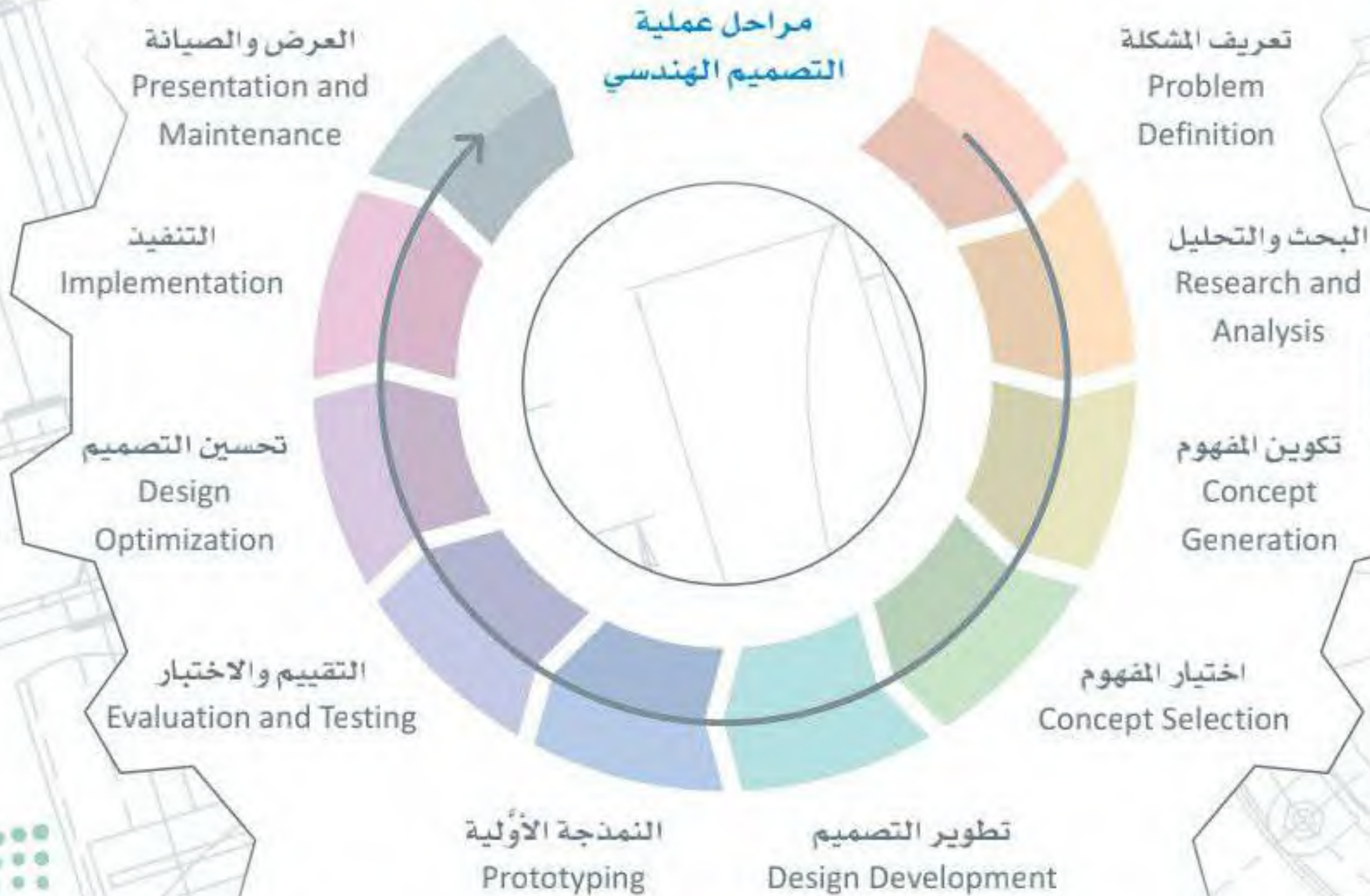
شكل 1.1: مراحل عملية التصميم الهندسي
