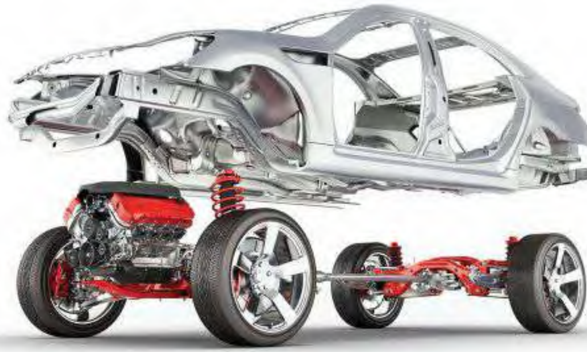
شكل 2.21: عرض تفصيلي لتجميع سيارة
