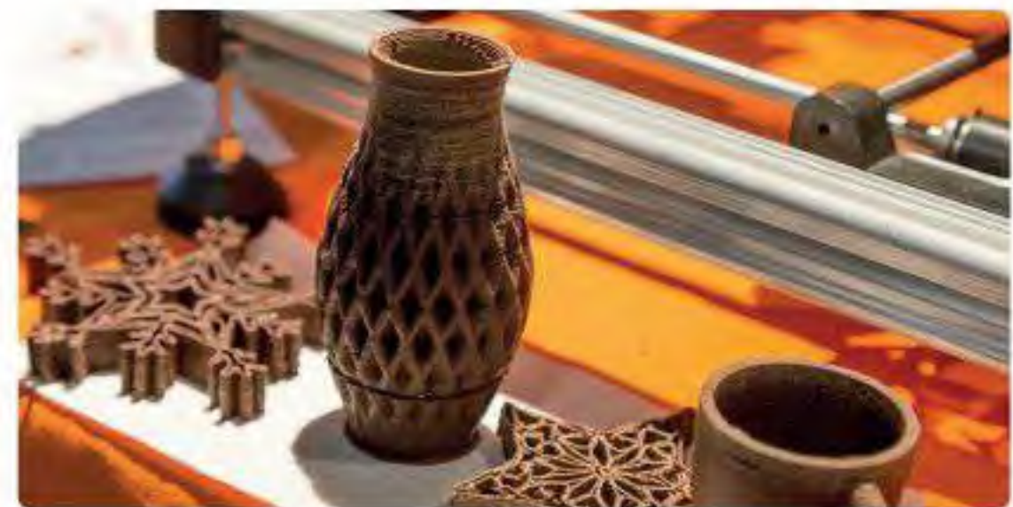
شكل 3.12: الطباعة ثلاثية الأبعاد بمادة السيراميك
