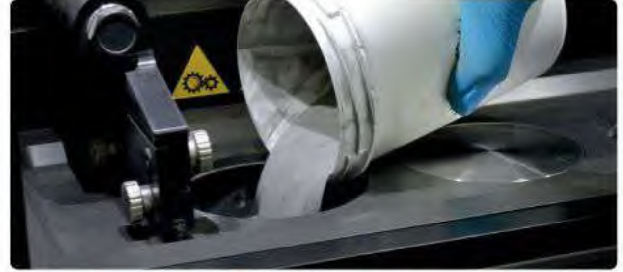
شكل 3.11: مسحوق الفولاذ المقاوم للصدأ للطباعة ثلاثية الأبعاد
