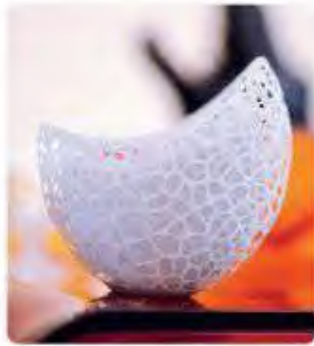
شكل 3.2: مجسم مطبوع بالبوليمرات الضوئية بواسطة طباعة ثلاثية الأبعاد
