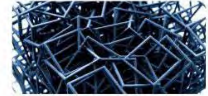
شكل 3.7: نموذج مطبوع باستخدام عملية النفث المادي
